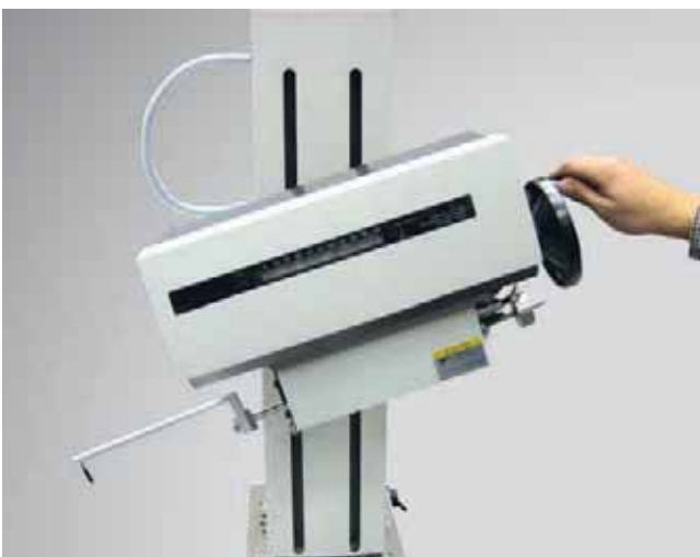
Optional: Handrad zum Schwenken des Vorschubs um \pm 15 Grad
