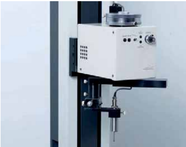
Optionaler Rotationsvorschub zur normgerechten Prüfung rotationssymmetrischer Werkstücke
