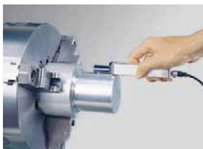
Vorsatzstück Welle E-WJ-S85A Vorsatz für das Freihandmessen auf Wellen und Zylindern.
