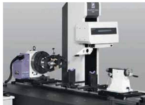
SURFCOM C5 Typ S: mit zusätzlicher Rotationsachse zur Messung von Kurbel- und Nockenwellen
