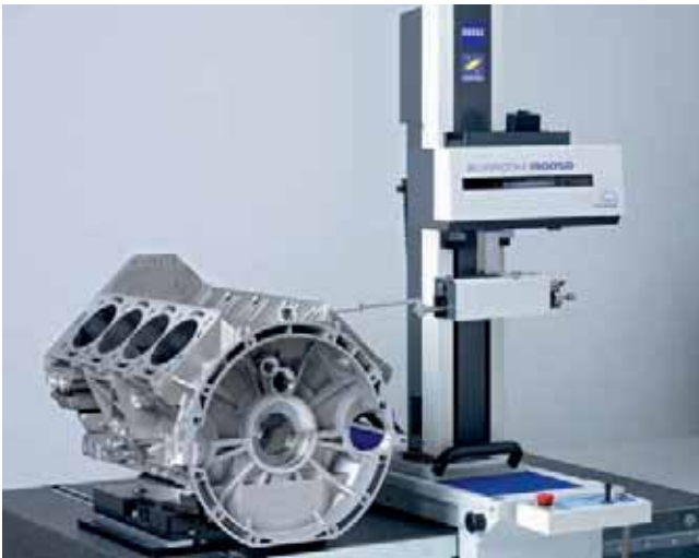
Individuelle Sonderlösungen wie dieser XY-Verfahrtisch sind auf Anfrage erhältlich
