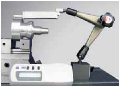
Magnetständer mit Kugelgelenken Flexibel ausrichtbarer Magnetständer mit zwei Kugelgelenken und einem Drehgelenk.
