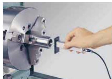
Führung rechtwinklig E-WJ-S86A Ausrichtehilfe für die sichere Ausrichtung rechtwinklig zur Auflagefläche.
