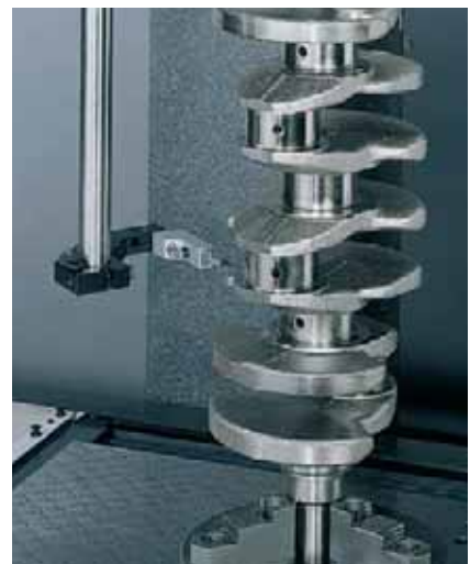
Kurbelwellen gehören zu den Hauptanwendungen der Spindelformtester von Carl Zeiss
