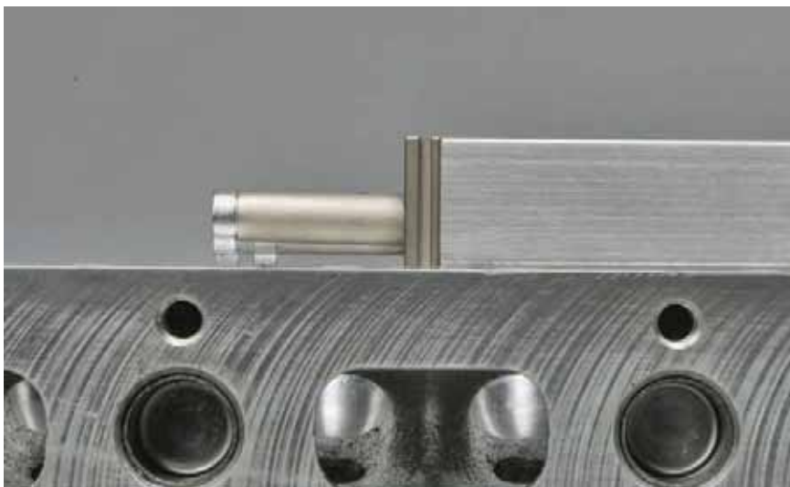
Flexibel im mobilen Einsatz: Die Vorschubeinheit kann von der Anzeigeeinheit getrennt genutzt werden.
