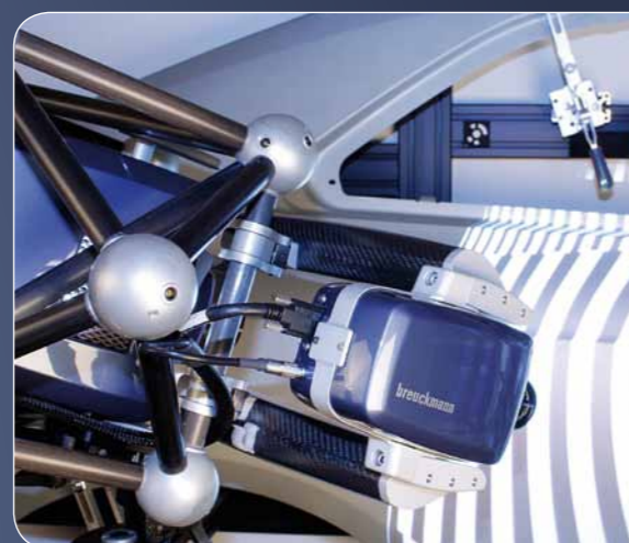
... wird bei der Erfassung großer Bauteile Breuckmanns naviSCAN 3D .
